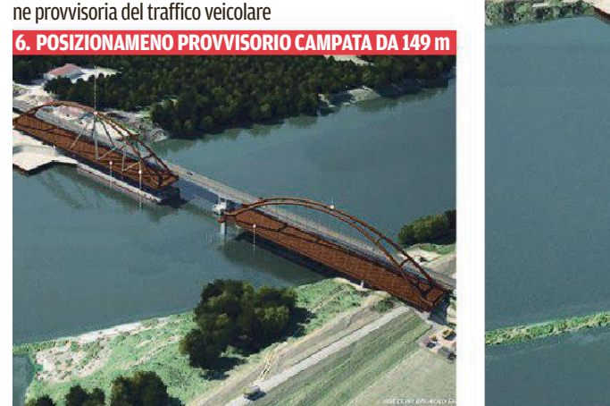
6. POSIZIONAMENTO PROVVISORIO CAMPATA DA 149 m
